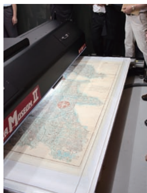
移動や持ち出しが困難な原本などを、 保管場所まで搬送しスキャンできるス キャナーは2×2メートルの大判サイズ までを対応。これまでの経験から得た 機能が盛り込まれている
